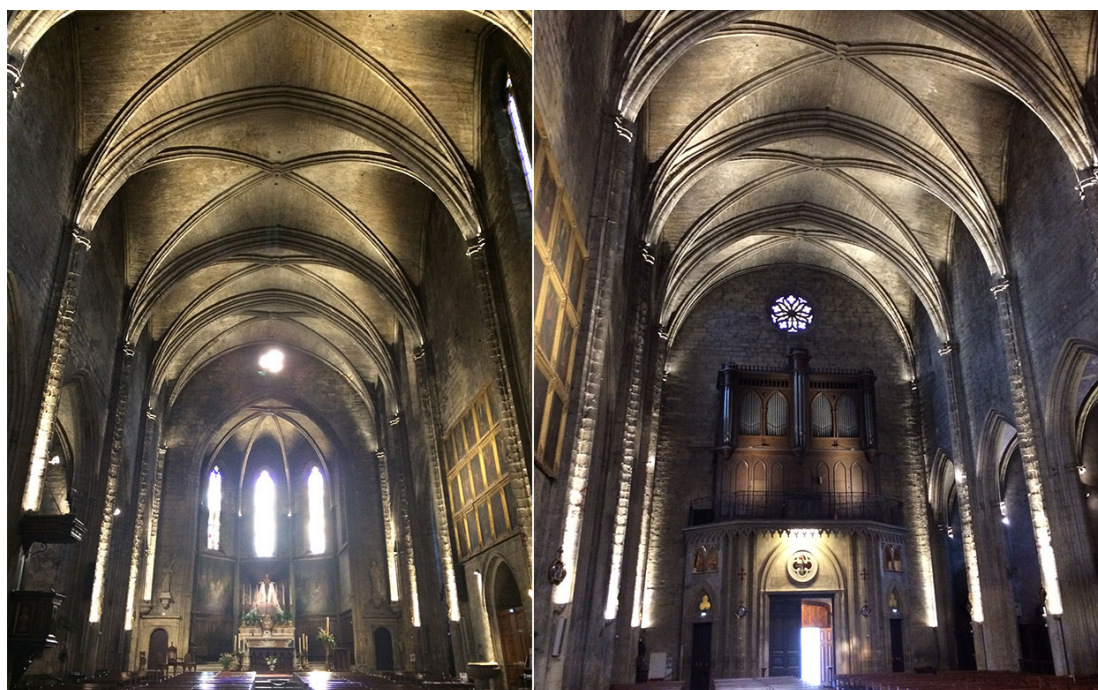
La voûte de la Collégiale est éclairée par 44 projecteurs 4040T-Luminy 4 en 3W blanc chaud, optique 20°.
