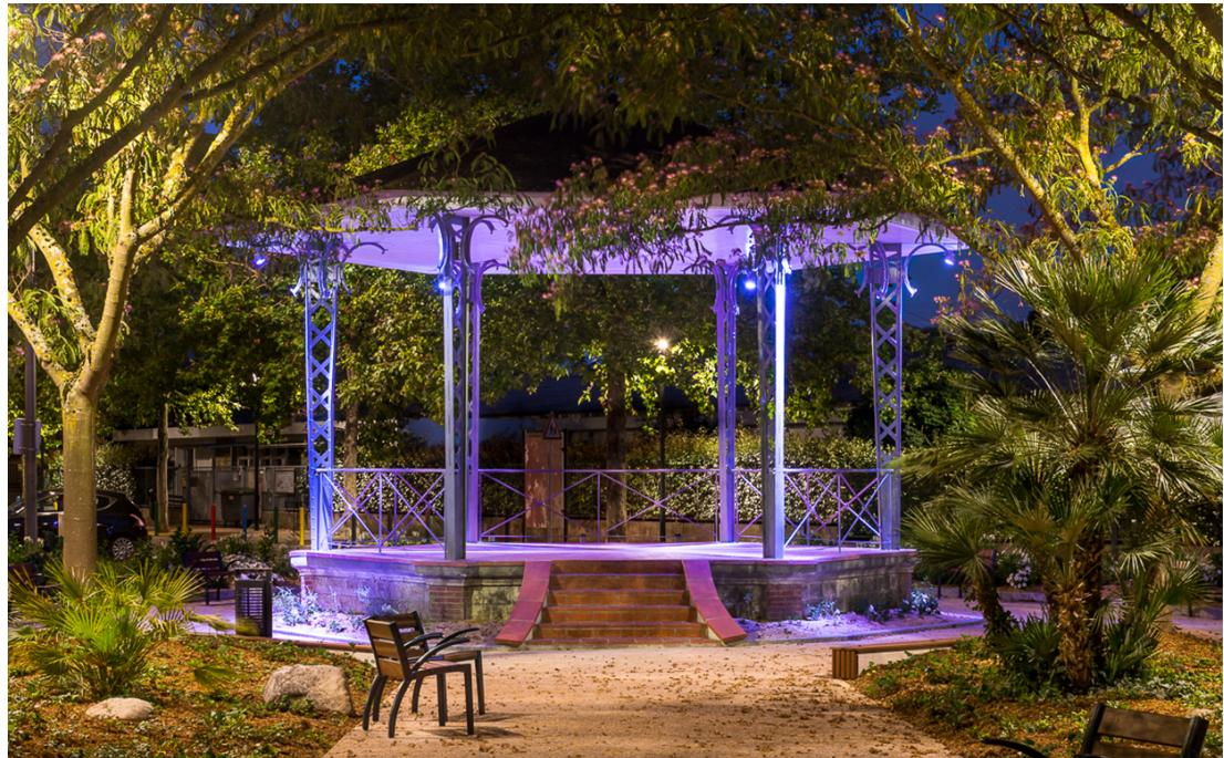
*Des traits lumineux au sol sont tracés sur tout le périmètre hexagonal du kiosque par 6 projecteurs sur lyre 4040-Luminy 4, chacun installé sur un pilier.*
