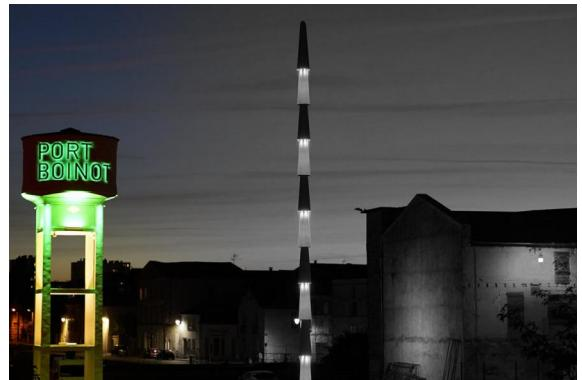
Des barreaux LIMA (5680) avec optique de 10° en blanc chaud 2700K et en vert mettent en lumière le château d'eau. Les barreaux et leurs pattes de fixation sont peints dans une couleur spécifique qui leur permettent de se fondre dans le paysage en pleine journée. Les barreaux sont pilotables en DALI.
