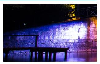
Les flancs des rampes d'accès sont éclairés par 4 projecteurs 4040-Luminy 4 en RGBW, optique 20°
